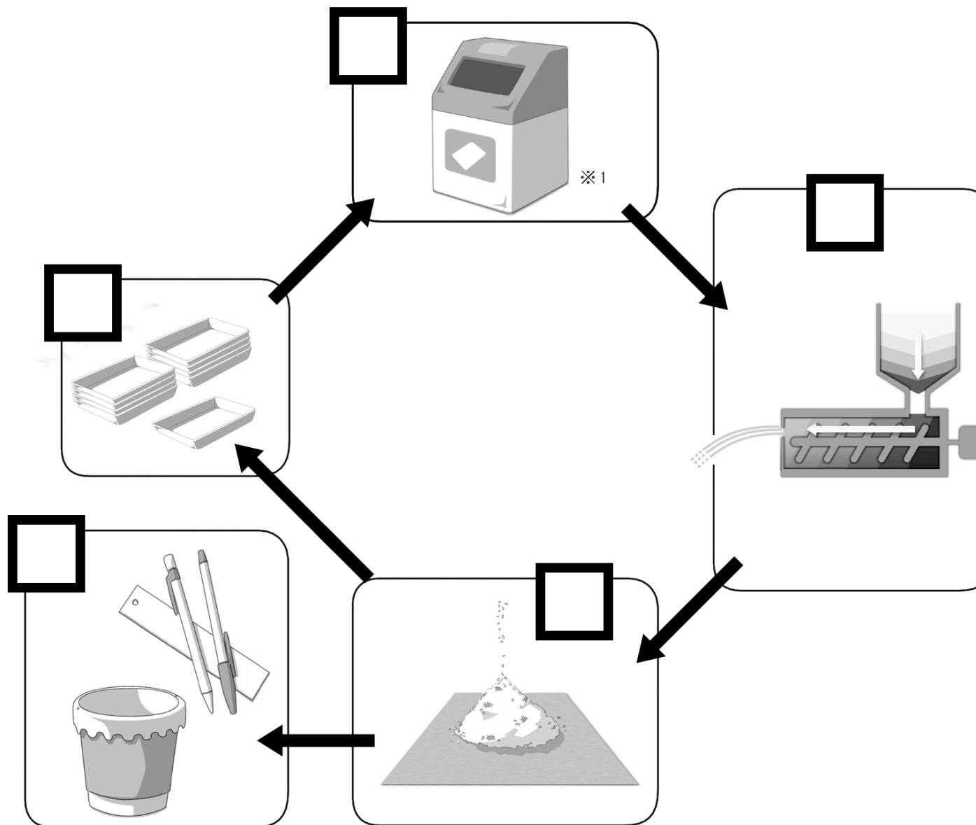
1 固形化した食品トレイを、製品にしやすいようにするため、ペレット(粒状のもの)にする。
