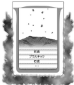
コークス炉では密閉した炭化室内で原料を無酸素状態のまま約1,200℃まで加熱し、熱分解する。その過程で投入された廃プラスチックは、200～450℃で熱分解し、高温ガスを発生しながら500℃でほぼ完全に炭化する。熱分解により発生した高温ガスからは炭化水素油とコークス炉ガスが得られ、残さとしてコークスと同等の働きをする還元剤が回収される。
