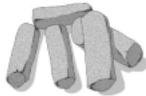
コークス炉内での化学反応(熱分解)を効率的に行うには、廃プラスチックを筒状にする必要がある。
